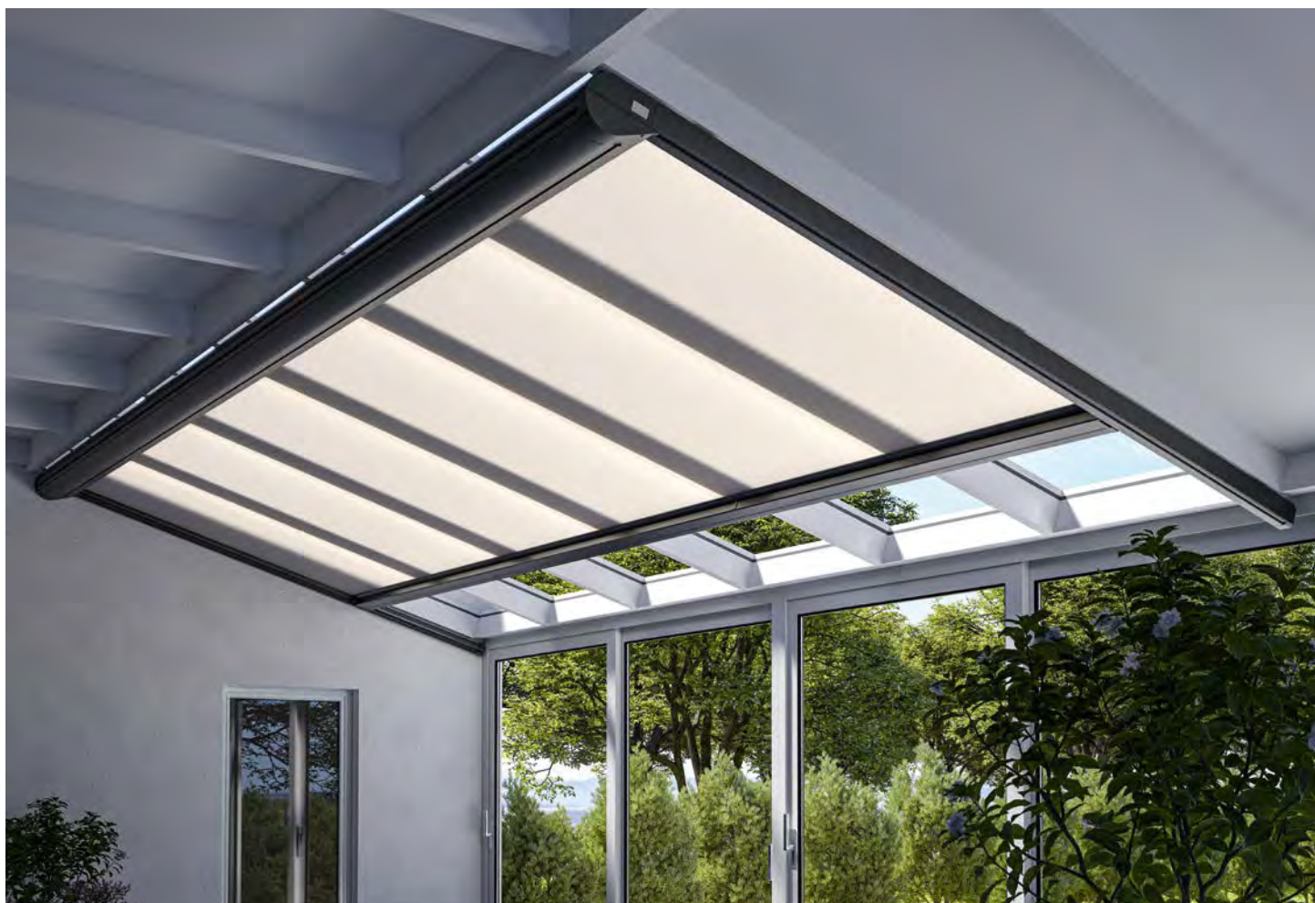
Glattes Tuch und lückenloser Sonnenschutz durch Schienen mit seitlicher Zip-Tuchführung und patentierter Ausgleichsfedertechnik.
